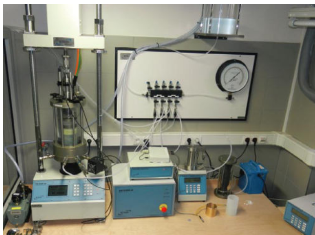
Rys. 1. Aparat trójosiowego ściskania będący na wyposażeniu Laboratorium Katedry Geotechniki i Wytrzymałości Materiałów Politechniki Krakowskiej
