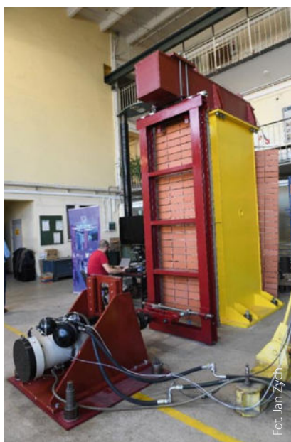
Rys. 2. Stanowisko badawcze kurtyny Flexbrick w L-12
