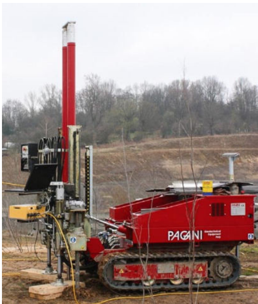
Rys. 2. Sonda statyczna Pagani pracująca w terenie
