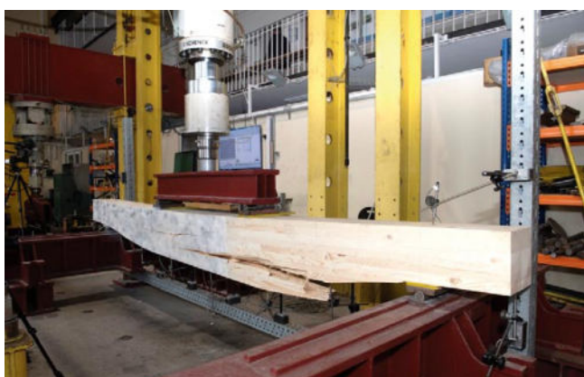
Rys. 2. Belka z drewna klejonego podczas badania na stanowisku w systemie badawczym Instron Schenck Testing System (źródło: archiwum laboratorium)
