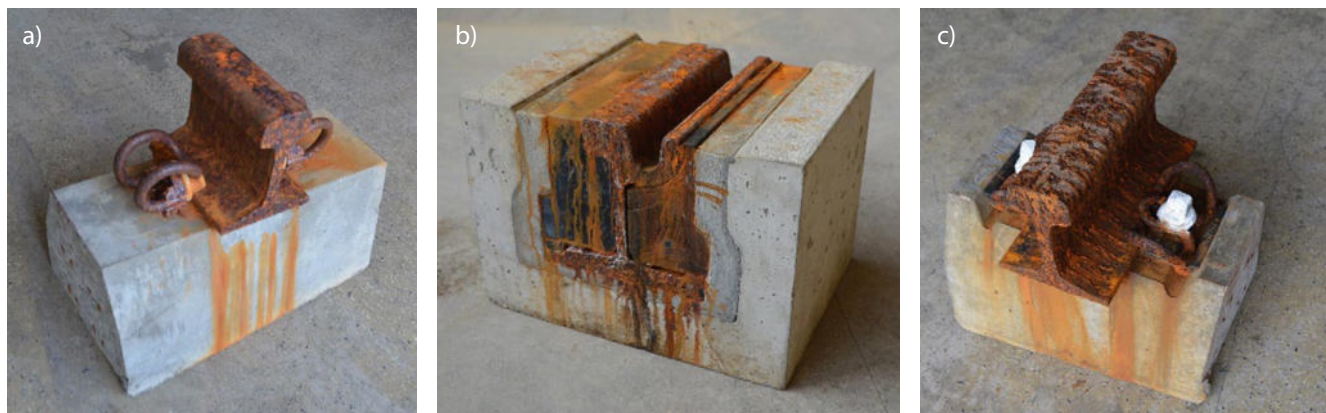
Rys. 7. Wybrane systemy przytwierdzenia po 300 h ekspozycji na działanie mgły solnej: a) system przytwierdzenia SB, b) system przytwierdzenia szyny w otulinie, c) system przytwierdzenia W14 (źródło: archiwum laboratorium)
