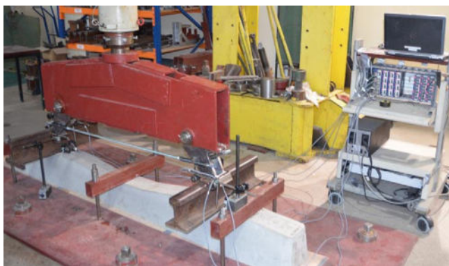
Rys. 5. Przykład ilustrujący badanie skutków obciążeń powtarzalnych systemu przytwierdzenia posadowionego na podkładzie betonowym (źródło: archiwum laboratorium)
