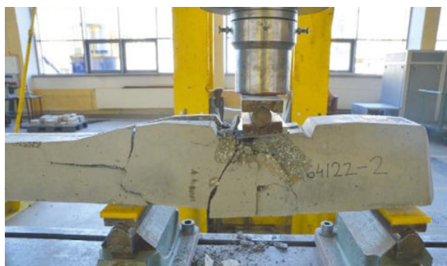
Rys. 3. Widok zniszczonego w strefie podszykowej podkładu strunobetonowego po zakończonym badaniu (źródło: archiwum laboratorium)
