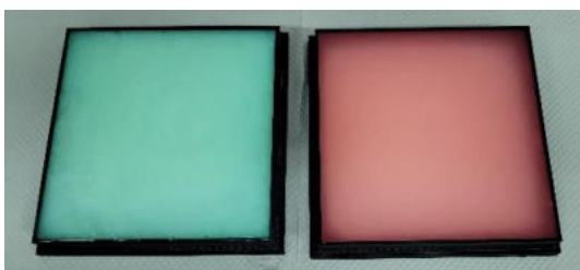
Próbki znakowanych luminescencyjnie nowych systemów Pressure Sensitive Paints (PSP)
