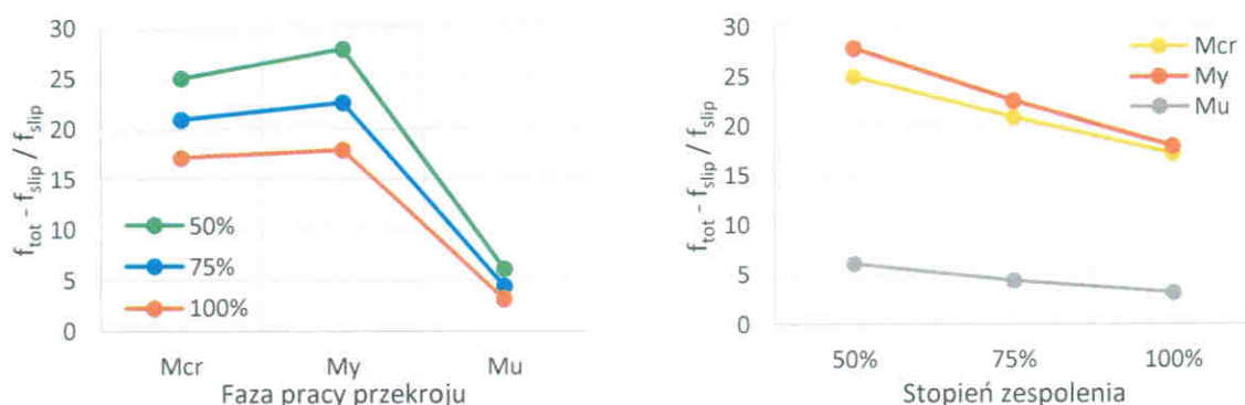
Rys. 0.2. Porównanie relatywnego ugięcia w odniesieniu do: fazy pracy przekroju oraz stopnia zespolenia
