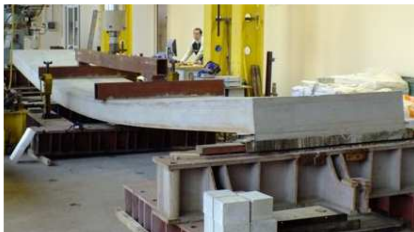
Fot. 3. Widok ugięcia stropu o rozpiętości 10.30 m, podczas badania
