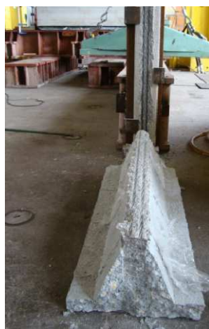
Fot. 1, fot. 2. Widok ścienia podłużnego prefabrykatu, uzyskiwanego w badaniach etapu II
