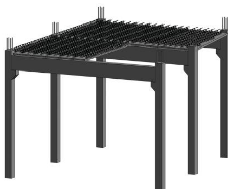
Oparcie stropu tarasu wykonane z płyt Filigran na prefabrykowanych belkach
