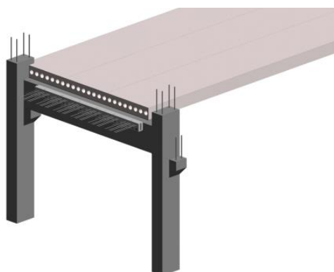
Oparcie płyty HC na belce z Iskorbem do montażu betonowych doni
