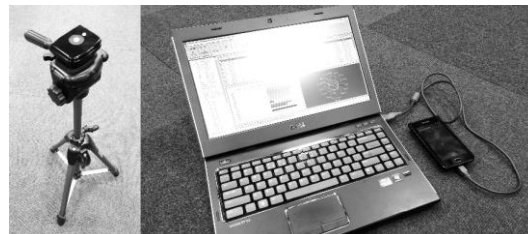
Statyw z założoną bezprzewodową głowicą pomiarową miernika SFIM-300 oraz baza miernika SFIM-300 oraz komputer wraz z oprogramowaniem pomiarowym.
