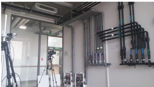
Tory pomiarowe w jednym z pomieszczeń badanych. Widoczna również kamera termowizyjna używana w celu weryfikacji poprawności pracy systemów
